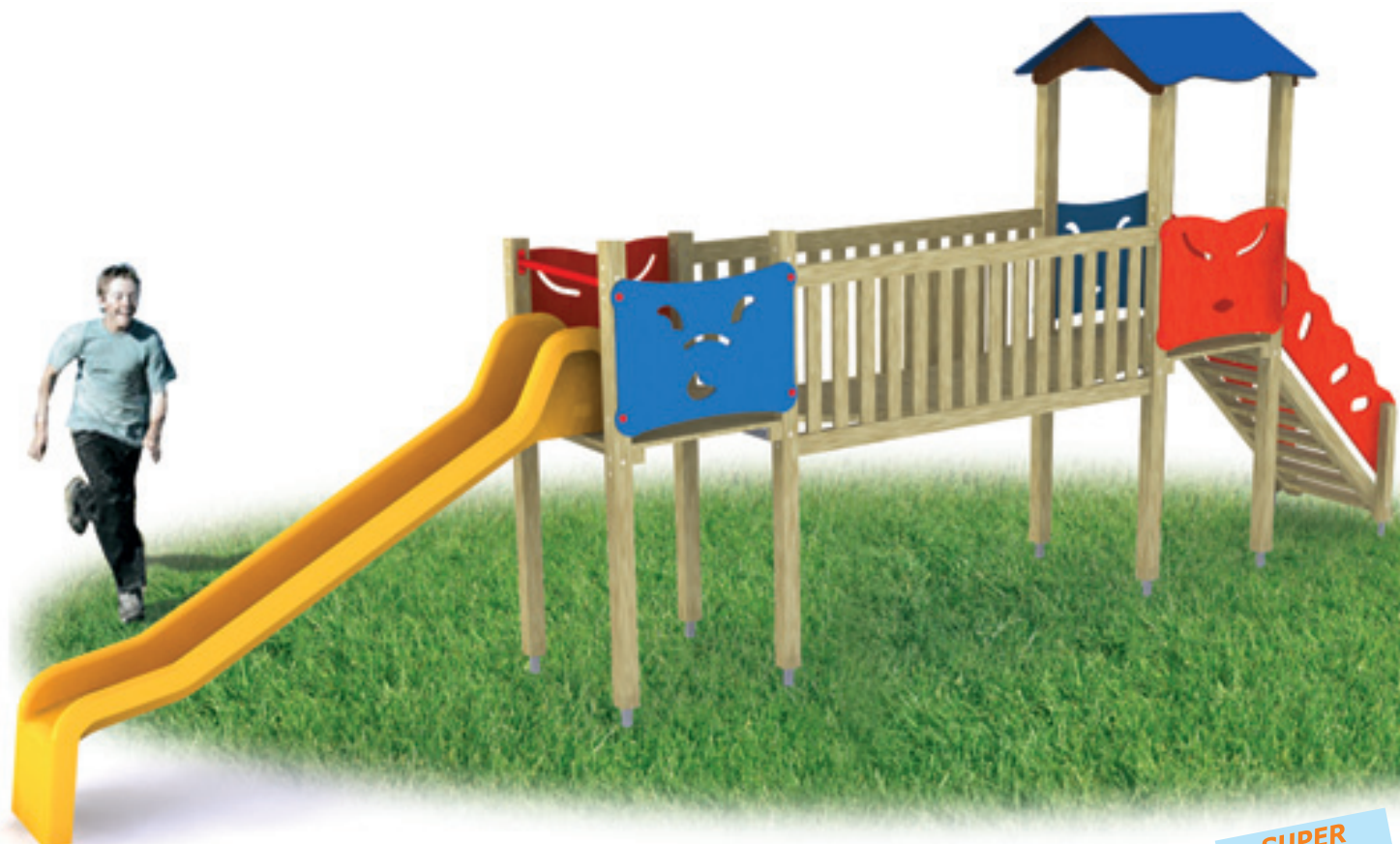
T820 - VILLAGGIO OREGON, n. 1 torretta con tetto, n. 1 torretta senza tetto, scivolo, scala di risalita con corrimano, ponte, dim. cm. 550x350x315 h, età d'uso 2/8 anni - H di caduta cm. 134, area di sicurezza mq 40, fissaggio con staffe in acciaio da interrare. (a richiesta con staffe di fissaggio a pavimento)
